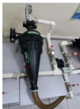
Рисунок 1 - Общие виды разработанной конструкции мини ГЭС в целом (а) и ее лабораторной модели (б)
