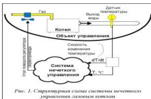
Рисунок 4 – Структурная схема системы нечеткого управления биогазовым котлом
