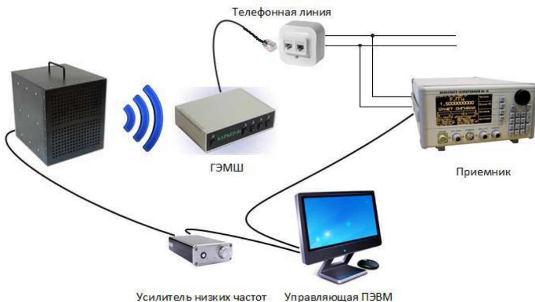
Рисунок 3 - Схема проведения измерений ГЭМШ по телефонной линии.
