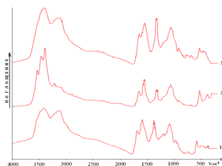
Рисунок 1 – ИК-спектры немодифицированных (1), модифицированных серной (2) и азотной кислотами (3) гуминовых кислот
