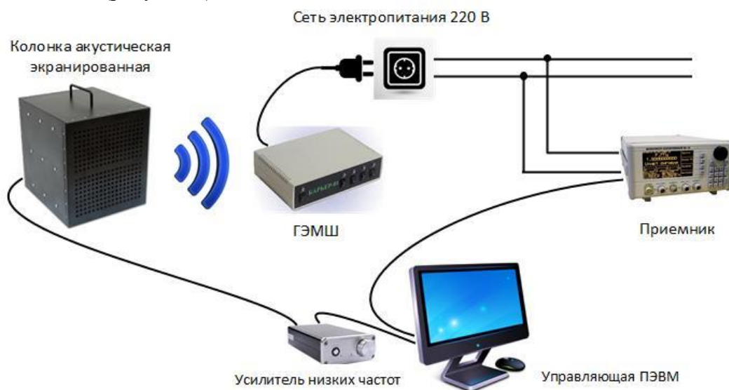
Рисунок 2 - Схема проведения измерений ГЭМШ по линии электропитания.
